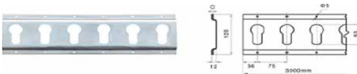
B9005 Profilo per barra appendiabiti Acciaio zincato , spessore mm 1,5, Lunghezza mm 3000 Rif.
