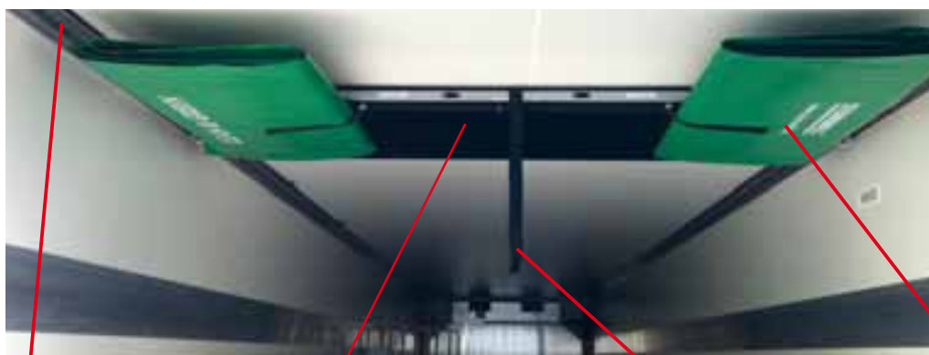
Rotaie di scorrimento con sistema di bloccaggio
