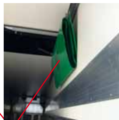
Le doppie porte sono molto leggere si ripiegano e si fissano sottotetto o lateralmente, perdita max in altezza 18 cm.
